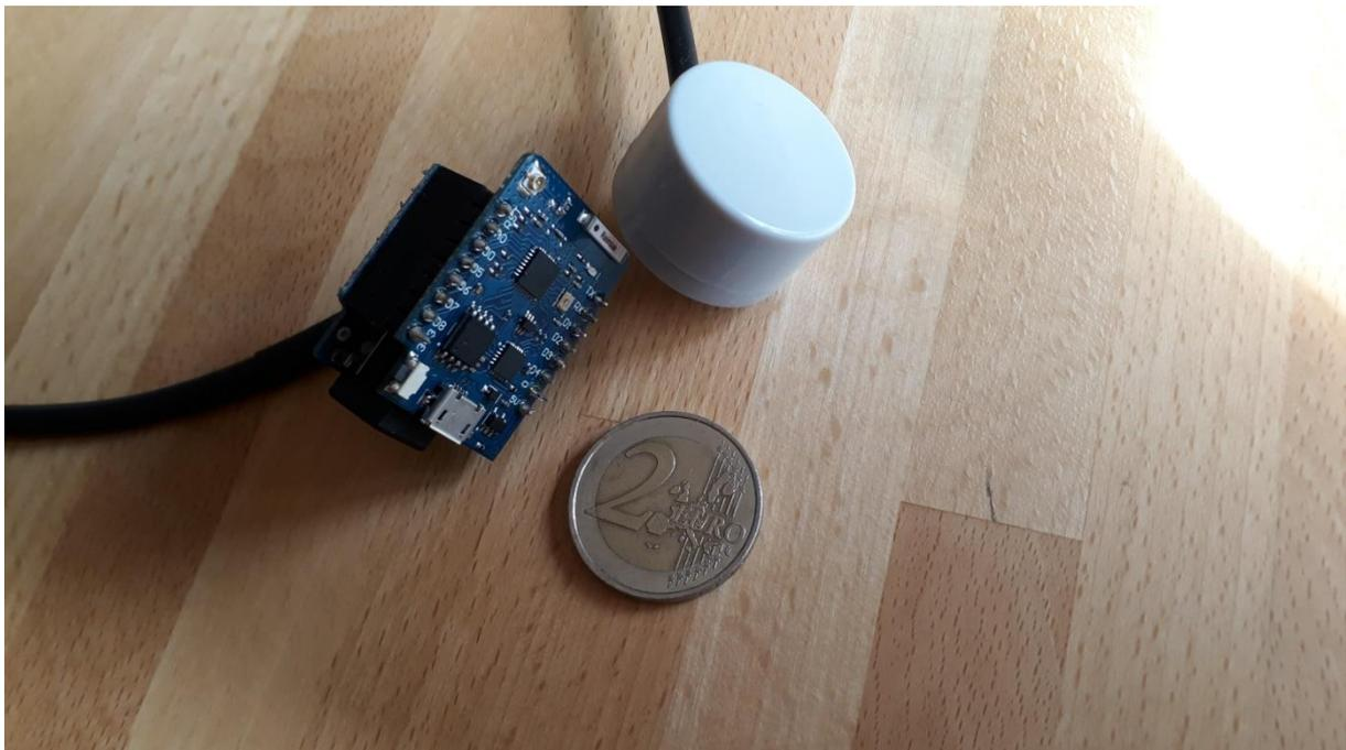
Abbildung 7 Wemos und Shield zusammengesteckt
