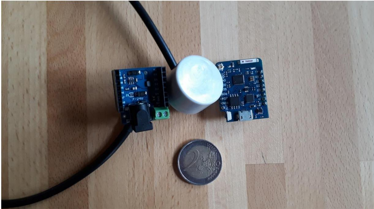
Abbildung 6 Stromversorgungshield, Sensor, Wemos (v.l.) Zum Größenvergleich 2-Euro Münze
